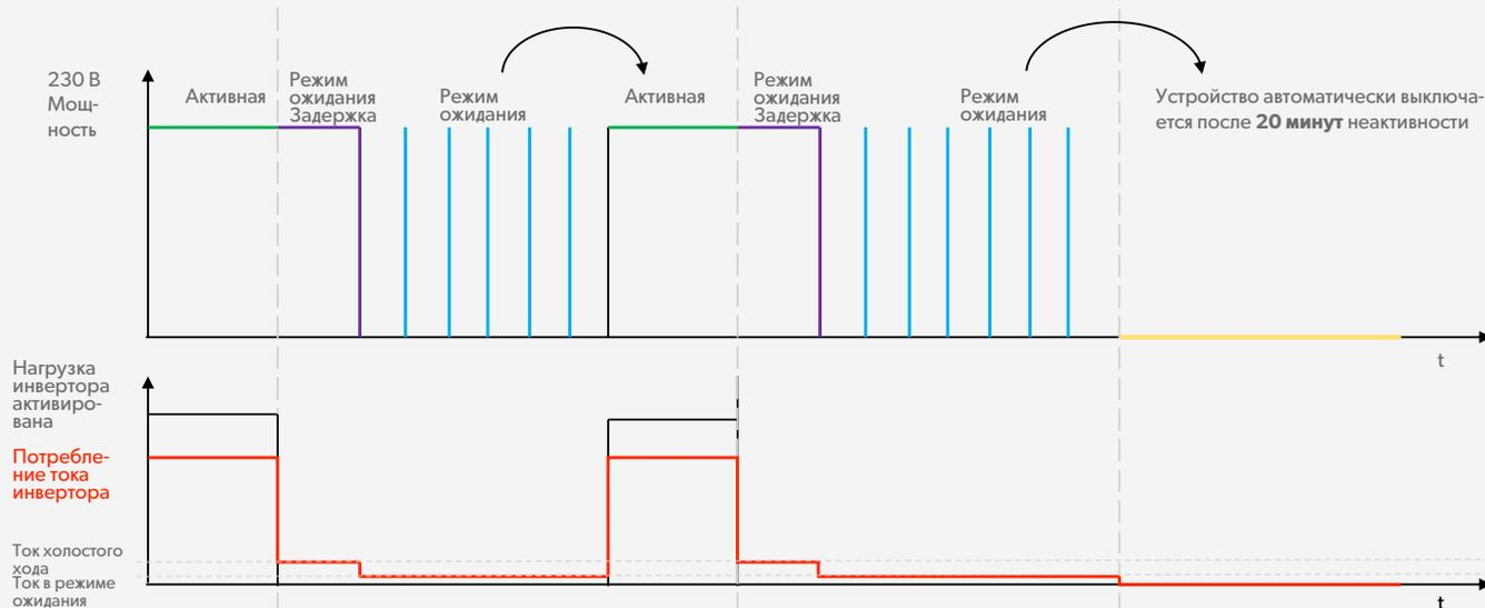
**АКТИВНЫЙ РЕЖИМ:** Инвертор генерирует напряжение 230 В переменного тока для питания присоединенной нагрузки. Он отбирает столько мощности постоянного тока от аккумуляторной батареи, сколько требуется, чтобы удовлетворить потребление энергии присоединенной нагрузкой.
