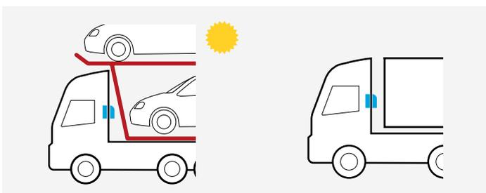
Для грузовиков с особо высокой кабиной, с надкрышным воздушным дефлектором или надстройкой (напр., автомобилевоз) Особо плоский блок накрышного испарителя — нет проблем с соблюдением допустимой общей высоты.
