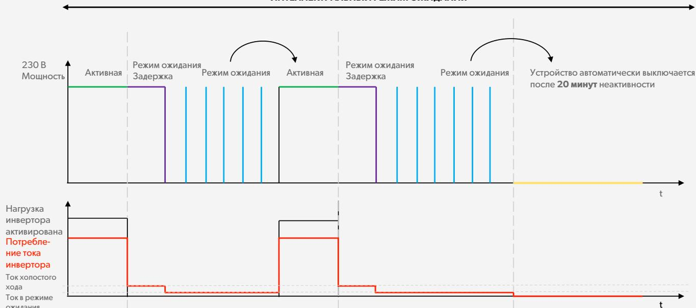
**АКТИВНЫЙ РЕЖИМ:** Инвертор генерирует напряжение 230 В переменного тока для питания присоединенной нагрузки. Он отбирает столько мощности постоянного тока от аккумуляторной батареи, сколько требуется, чтобы удовлетворить потребление энергии присоединенной нагрузкой.
